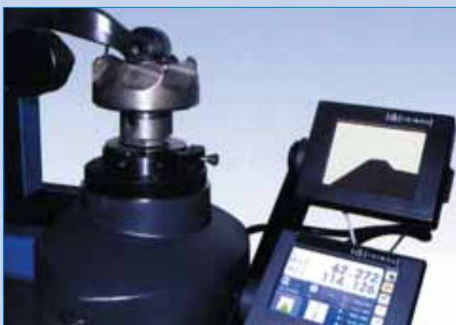
Kontrola nožové frézovací hlavy
