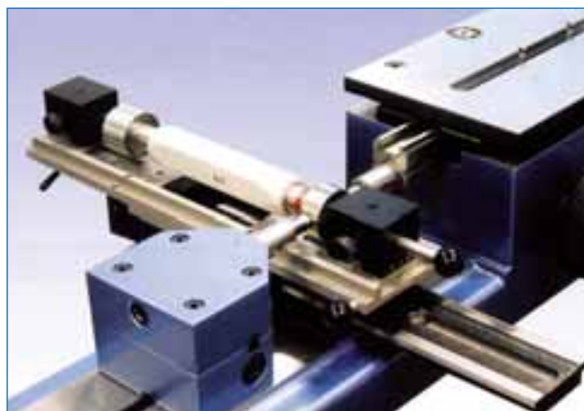
Kontrola hladkých a závitových kalibrů (TELS6)
